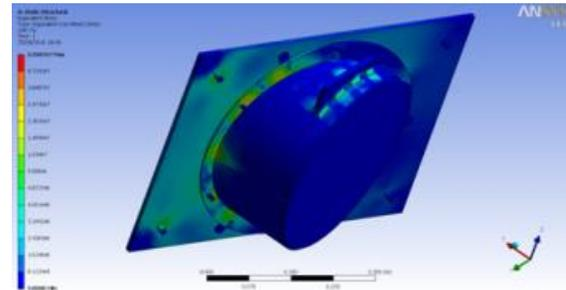
Fig. 7 Equivalent stress, 5,6e7Pa
